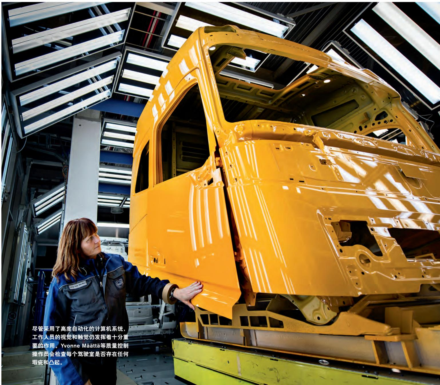
尽管采用了高度自动化的计算机系统，工作人员<sup>的</sup>视觉和触觉仍发挥着十分重要的作用。Yvonne Määttä等质量控制操作员会检查每个驾驶室是否存在任何瑕疵和凸起。
